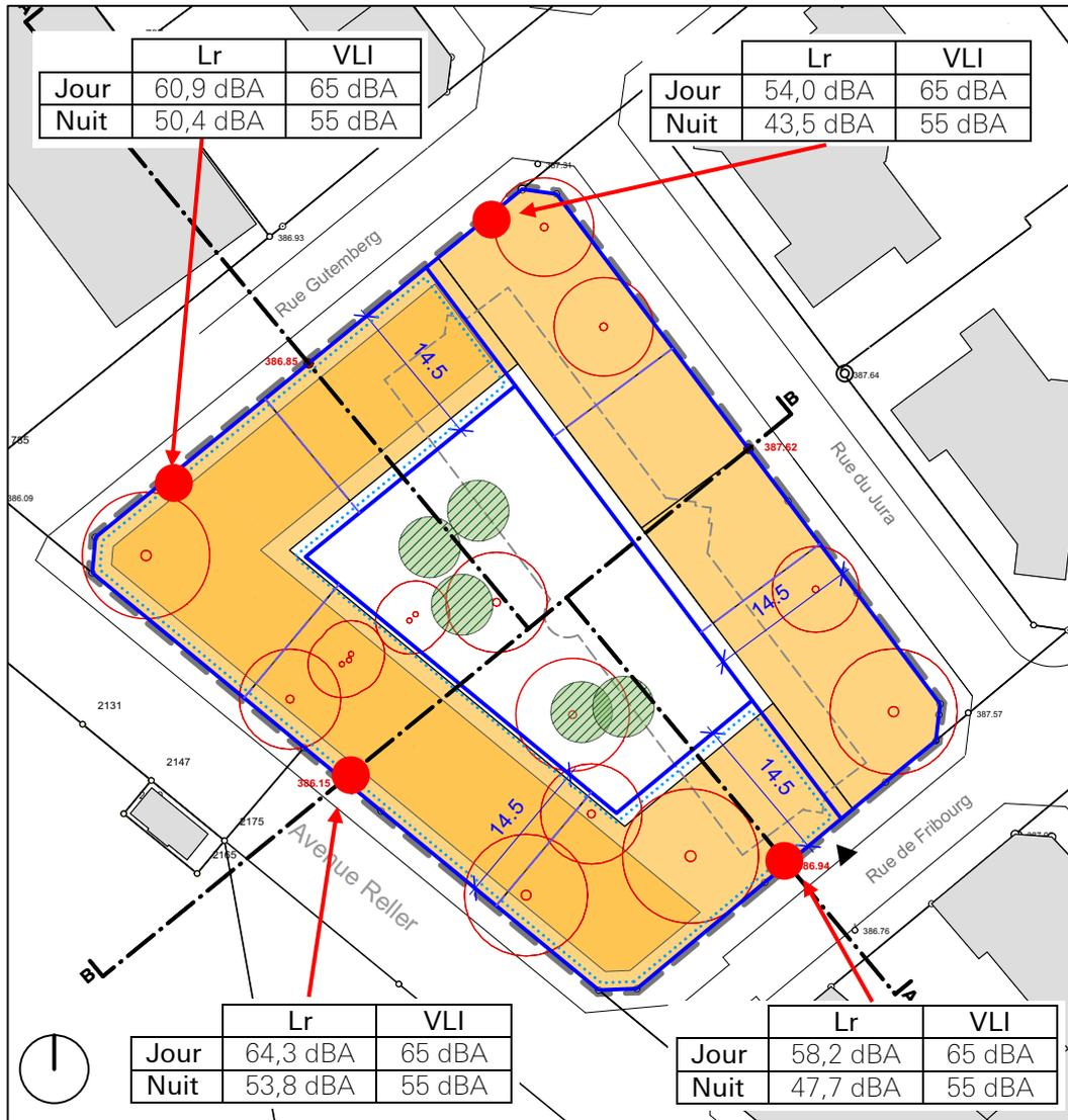
Fig. n° 7: Niveaux d'évaluation sonore diurnes et nocturnes en façade des futurs bâtiments
