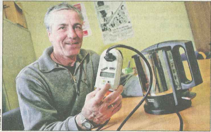
Michel Bloch, délégué à l'Agenda 21 veveysan: «Les wattmètres permettent de traquer les «voleurs» de courant.»
